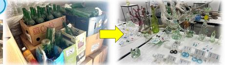
✓廃ガラスを溶かすために、廃プラスチックから産出した燃料を使っています。
